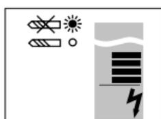
Das blinkende Symbol **⚡** und die rote LED-Anzeige **3** signalisieren eine **spannungsführende** Netzleitung. Sofern das Metall der Netzleitung im Erfassungsbereich des Gerätes liegt, schlägt die Balkenanzeige aus. Bei Annäherung vergrößert sich der Ausschlag. Mit Hilfe des maximalen Ausschlags kann die Lage der Netzleitung genauer eingegrenzt werden.
