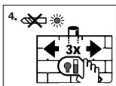
Bei einer Metallortung leuchtet die rote LED-Anzeige **3** und die Balkenanzeige im Display **4** schlägt aus.
