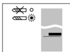
Nur wenn innerhalb des Suchbereichs die grüne LED-Anzeige **2** ständig leuchtet und die Balkenanzeige unverändert einen Balken anzeigt, wurde kein Metall und keine spannungsführende Leitung gefunden. Leuchtet die grüne LED-Anzeige und mehrere Balken werden angezeigt, ist keine eindeutige Aussage möglich.
