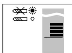
Findet das Gerät Metall, erlischt die grüne LED-Anzeige **2**, und die rote LED-Anzeige **3** leuchtet. Die Balkenanzeige im Display **4** schlägt aus.
