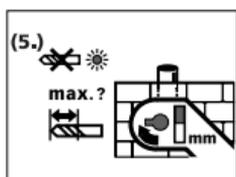
Wenn nach erfolgter Ortung (siehe Funktion „Suchen“) die Tiefe von Armierungen in Beton bestimmt werden soll, das Gerät zum Ort der maximalen Balkenanzeige bewegen.
